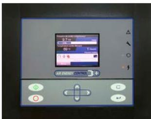
Le tableau de commande Air Energy Control est **très simple d'utilisation, très intuitif et complet.** Il gère, surveille et optimise en permanence le bon fonctionnement de la vis. Il permet la mise en route et l'arrêt du compresseur : touche marche/touche arrêt.
