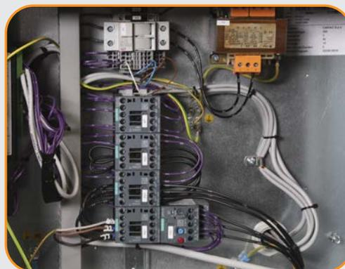
À partir du modèle 7,5 CV les compresseurs à vitesse fixe sont **tous équipés d'un démarrage étoile/triangle**.
