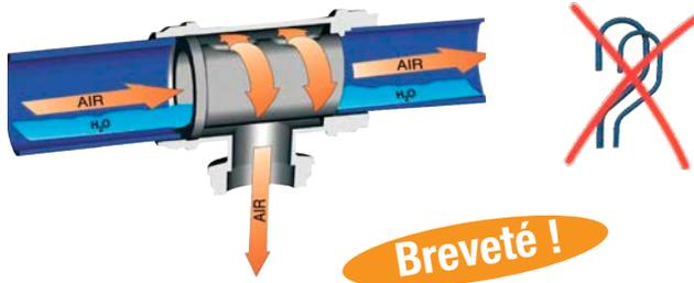
Le raccord en té pour descente est une alternative sérieuse au traditionnel «col de cygne».
