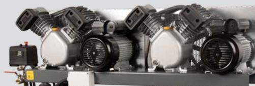
Le compresseur est équipé de série d' un contacteur manométrique intégrant un relais temporisé, **pour limiter la crête d'intensité au démarrage** : un ensemble moteur/groupe démarre en premier, une fois qu'il est en régime « de croisière » (**stabilisé**), le deuxième ensemble démarre à son tour.
